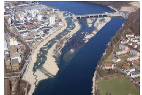
Das naturnahe Fließgewässer erstreckt sich über 900 Meter Länge mit einer durchschnittlichen Breite von 50 Metern. Hierzu wurden auf einer Vorschüttung von 265.000 m<sup>3</sup> rund 30.000 to Kalkblocksteine und 30.000 to Grobkies als Oberflächengestaltung verbaut. Außerdem wurden noch verschiedene Einzelbauwerke wie Fischzähleinrichtung, Flutungsöffnungen usw. aus über 1.000 m<sup>3</sup> Stahlbeton erstellt.
